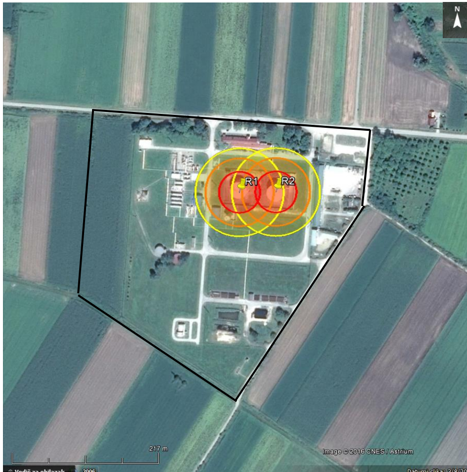
Slika 38. Zone ugroženosti uslijed istjecanja nafte iz spremnika R-1 i R-2 u tankvanu i nastanka požara
