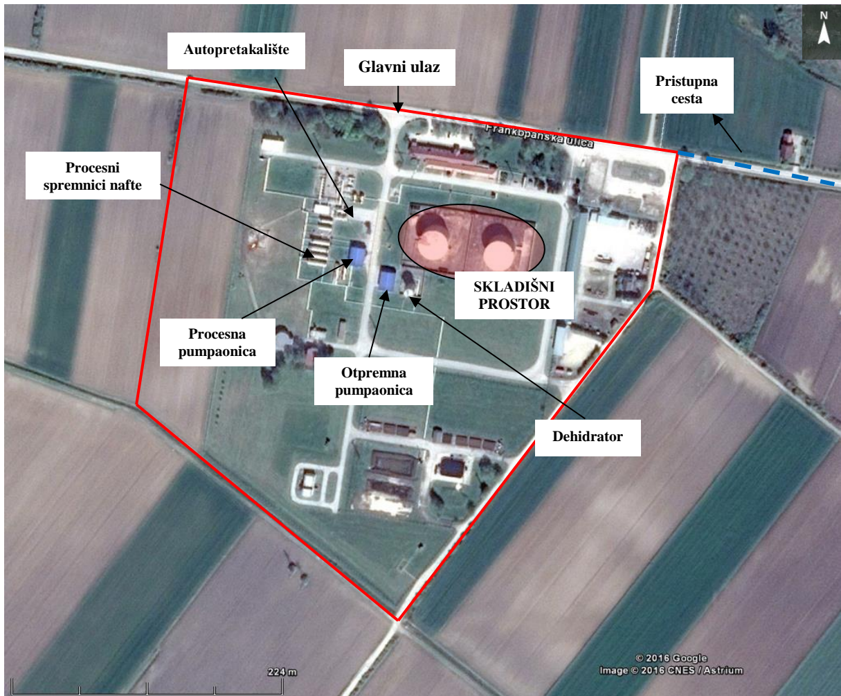
Slika 9. Dijelovi područja postrojenja MOS Đeletovci koji predstavljaju najveće opasnosti
