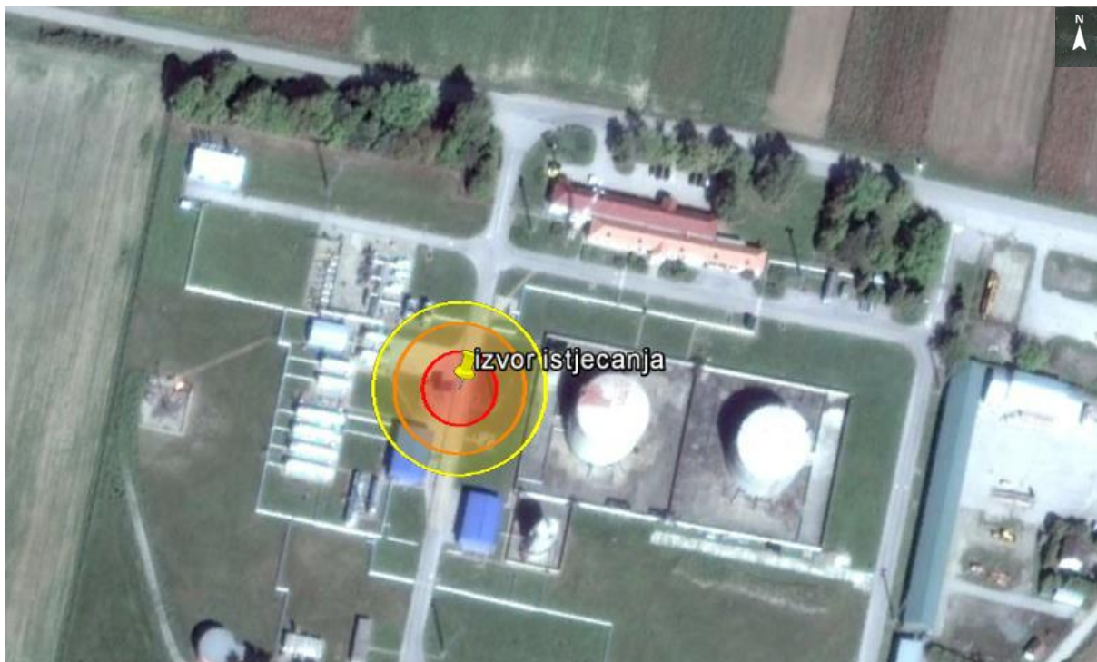
Slika 45. Zone ugroženosti uslijed istjecanja i zapaljenja nafte iz auto cisterne
