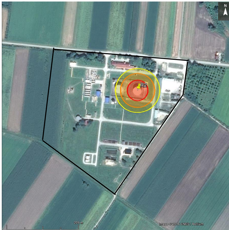
Slika 37. Zone ugroženosti uslijed istjecanja nafte iz spremnika R-2 u tankvanu i nastanka požara
