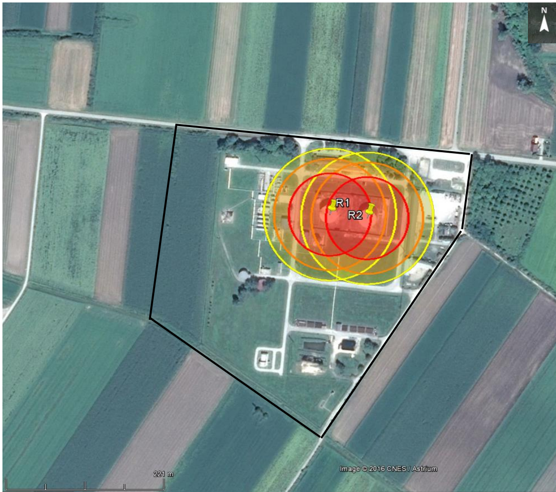
Slika 35. Zone ugroženosti uslijed istjecanja i zapaljenja medija iz spremnika R 1 i R2 (uz oštećenje tankvane)
